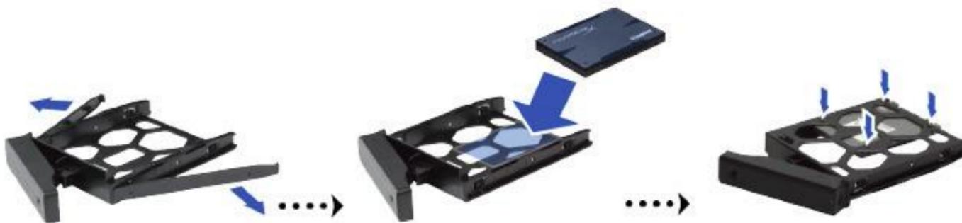
注意: 2.5 インチドライブでは固定パネルは使用しません。3.5 インチドライブを使用する際に備えて保管してください。
